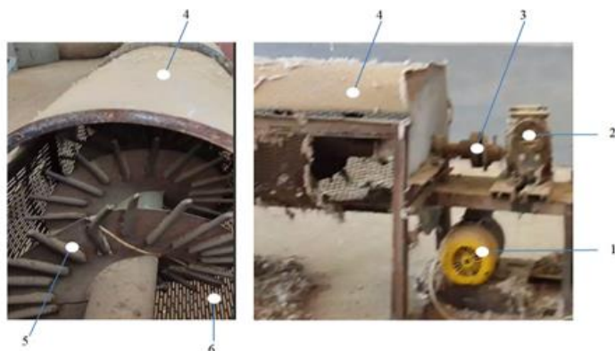
Рис. 1. Устройство для транспортировки и очистки хлопка: 1–электродвигатель; 2–редуктор; 3–муфта; 4–конвейер; 5–колковый шнек; 6–сетчатая поверхность.
