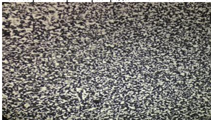
Рис. 2. Макроструктура стали марки 20ГЛ (x100)
